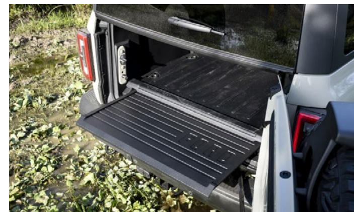
WYSUWANY STOPIEŃ POD PODŁOGĄ DRZWI BAGAŻNIKA
