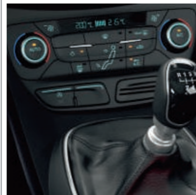
Elektroniczna klimatyzacja dwustrefowa z automatyczną regulacją temperatury (DEATC)
